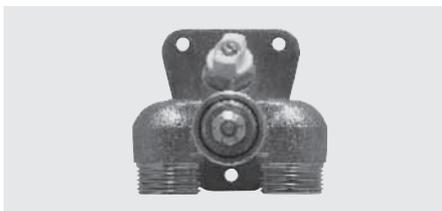
Soupape, coefficient kv 0,027 - 0,65, avec raccords filetés 3/4" eurocône, convient aux vissages par bague de serrage xnet, avec soupape de dégagement d'air.
